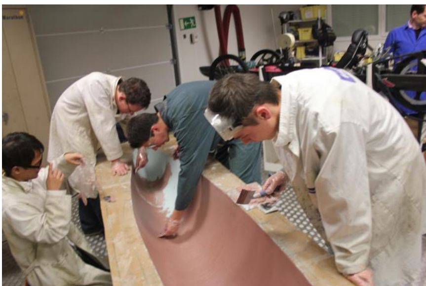
Application d'une couche de mastic
