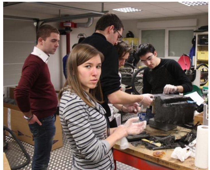
Application d'une couche de carbone sur la boîte
